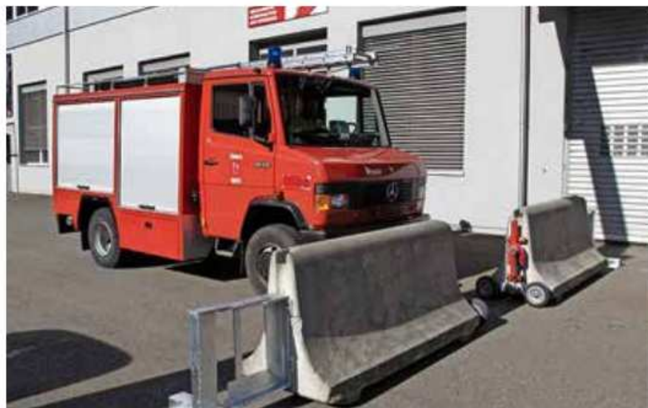
Avec le système développé à Wünnewil, déplacer des blocs de béton de plus de deux tonnes n'est plus un problème. Robor
